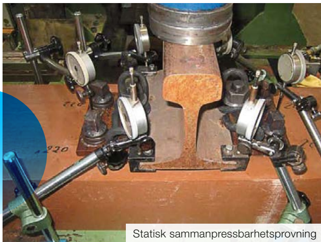
Belastning av FFU-slipper med räls och dess fästen vid slipern
