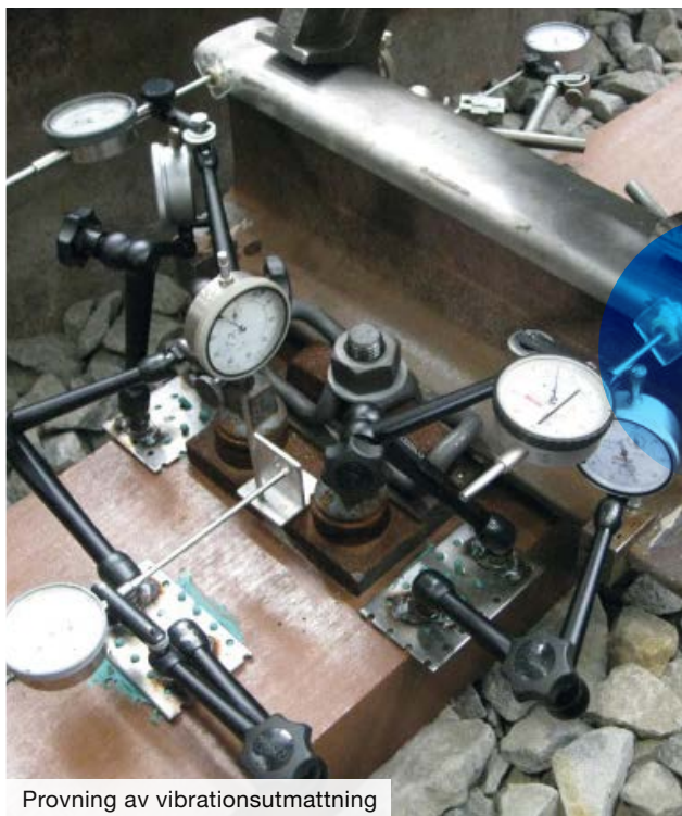
Utmattningsprov under spårstöd
